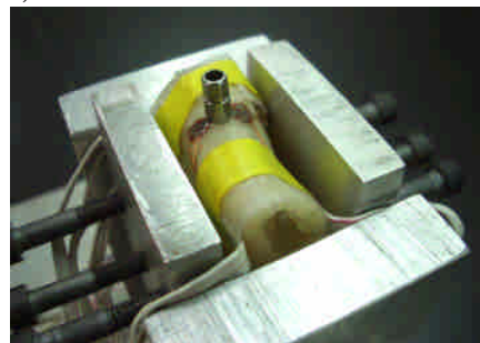
Fig 1. (a) 下方的模型為，不同緻密骨厚度之 RP 模型，右上方的模型為將實驗模型，其緻密骨部分為 Tempron 樹脂，疏鬆骨的部份為環氧樹脂，上方的模型為將人工牙根與應變規置入後，其完成後之實驗模型。(b)人工牙根(ICER self tapping implant, 3i Implant Innovation inc., Palm Beach, FL)與支台齒(Implant temporary hexed cylinder, 3i Implant Innovation inc., Palm beach, FL)。
